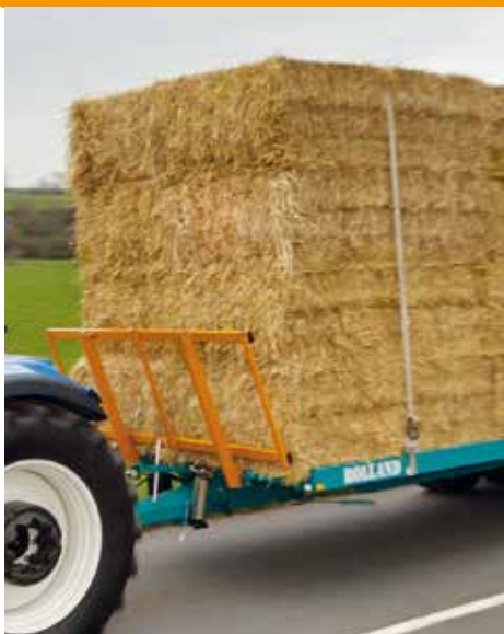
1 Hauteur 1 m droite et inclinable
